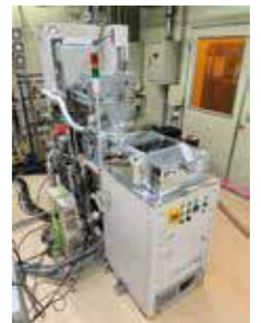
台湾陽明交通大学内に試験設置中の中性粒子ビームエッチャー試作機
